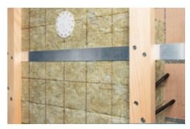
Pannello isolante a due stati con strato interno elastico e strato esterno più duro e intagli tra loro distanziati di 200 mm. Coibentazione sull'intera superficie di facciate ventilate per sistemi di ontaggio con viti distanziali e profilati angolari in alluminio.
